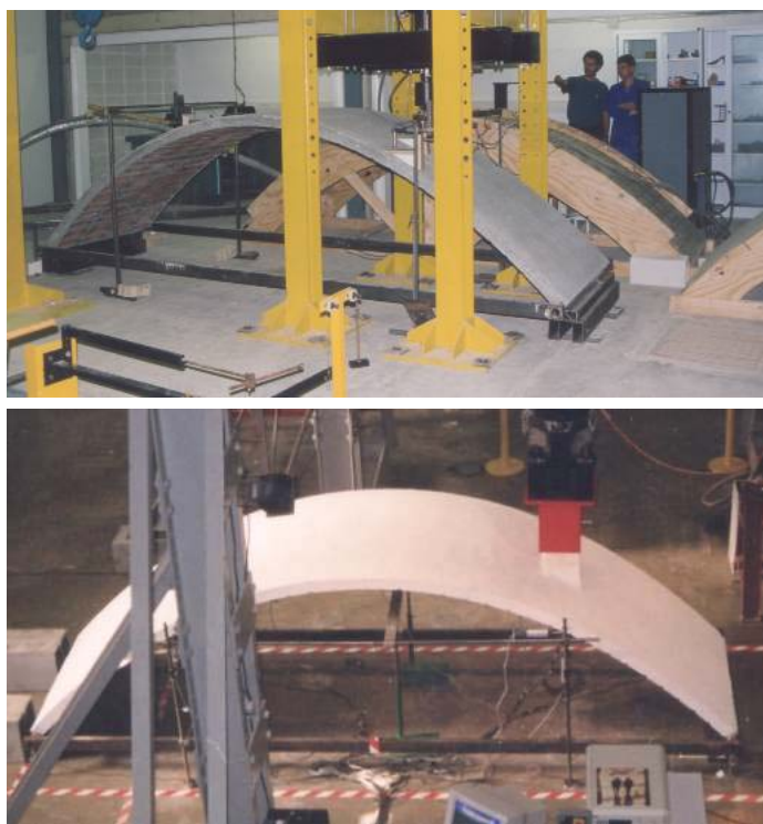
Fig.7 - Láminas bajo pórtico de carga
