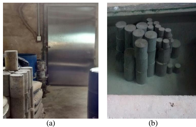
Figura 1 – Controle de umidade por meio de (a) câmara úmida e (b) tanque com água saturada com cal.
