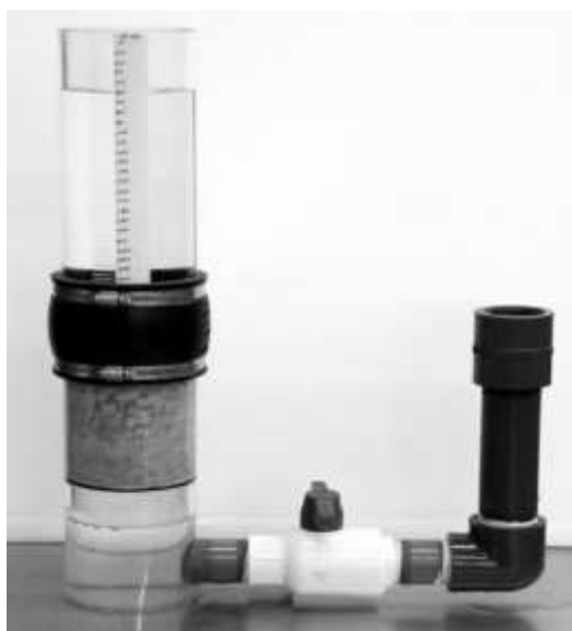
Figura 2 - Aparelho para medição da condutividade hidráulica (Neithalath et al. , 2003).
