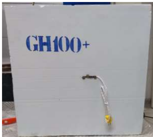
Figura 3 - Termopares na superfície fixadas com tachas metálicas no centro do bloco.
